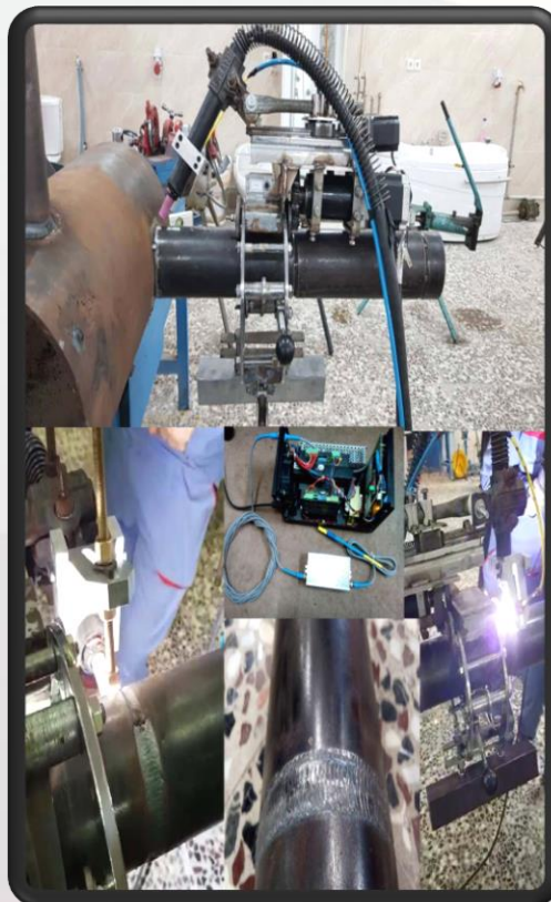
دستگاه اوریتال ولدینگ جوش خودکار خطوط لوله فلزی
